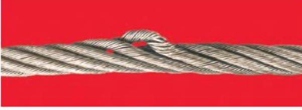
a. Damar çıkması ya da bükülmesi
