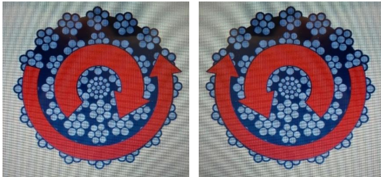
Düz bükümde ve ters bükümde halat tellerinin iç hareketi
