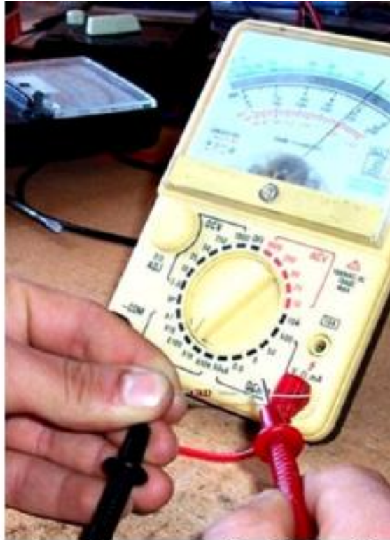
Resim 2.1: Avometre ile direnç ölçümü
